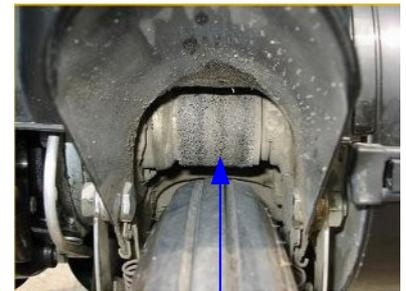
Galet débrayé ici, qui vient frotter directement sur la roue quand le Solex est en marche
