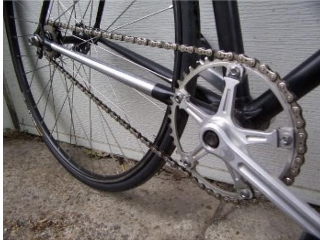
Il s'agit d'un montage hybride entre les poulies – courroie et les engrenages.
